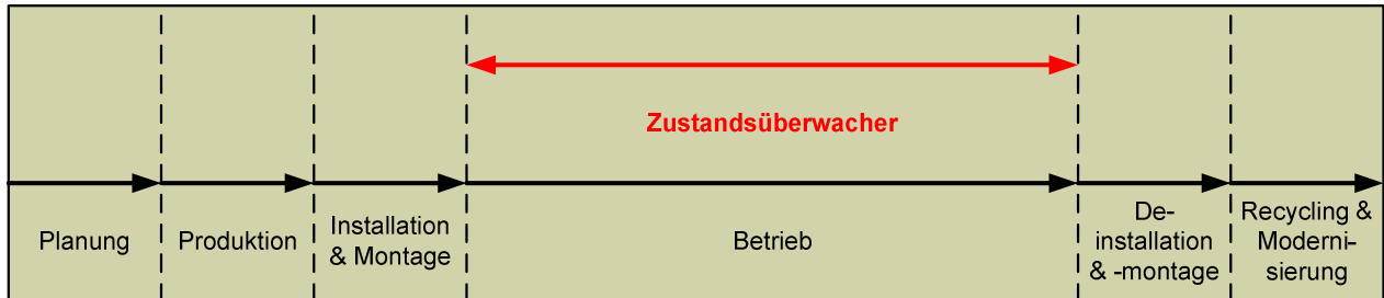
Abbildung 5.4: Einordnung des Zustandsüberwachers im Produkt-Lebenszyklus
